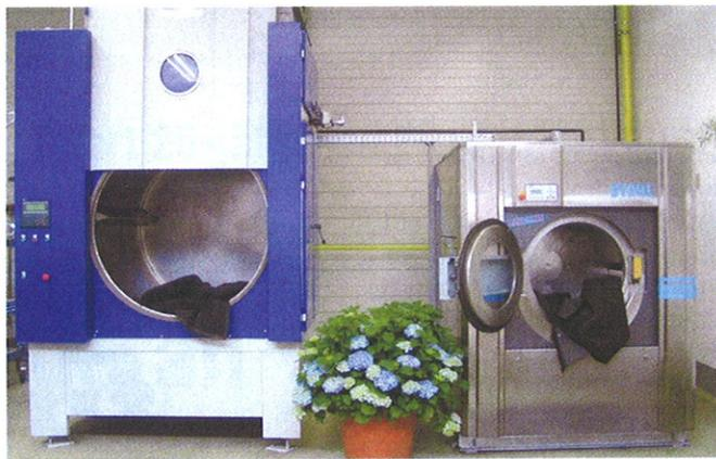
Die industrielle Waschmaschine (r.) und der industrielle Trockner haben bei Hauck die Durchlaufzeiten bis zur Wiederverwendung der Schmutzfangmatten erheblich verkürzt
